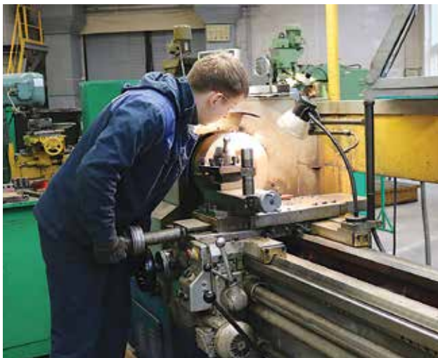
Токарь Алексей Зуев восстанавливает линзы холодильников E-8 цеха № 105
